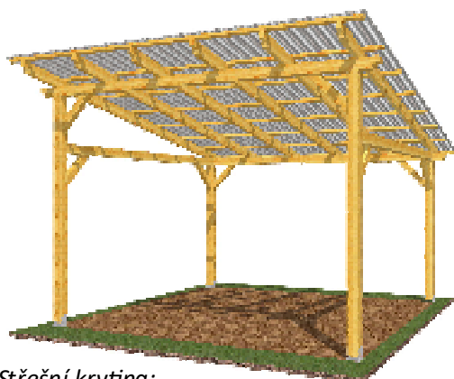
Střešní krytina: - polykarbonátové desky WT trapéz
