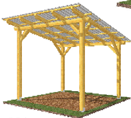
Střešní krytina: - polykarbonátové desky WT trapéz
