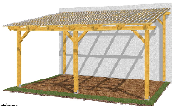
Střešní krytina: - polykarbonátové desky WT trapéz
